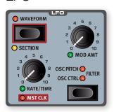
Le **LFO** ou *Low Frequency Oscillator* (oscillateur basse fréquence) produit des formes d'onde cycliques, et cela à très basse fréquence. Un LFO ne sert généralement pas à produire des fréquences *audibles*. La sortie du LFO sert plutôt à moduler d'autres fonctions, comme le paramètre *Osc Ctrl* de l'oscillateur du Nord Stage 4 ou la *fréquence du filtre*. La vitesse du LFO se règle avec le bouton **RATE/TIME** qui est contrôlable par *morphing*.
